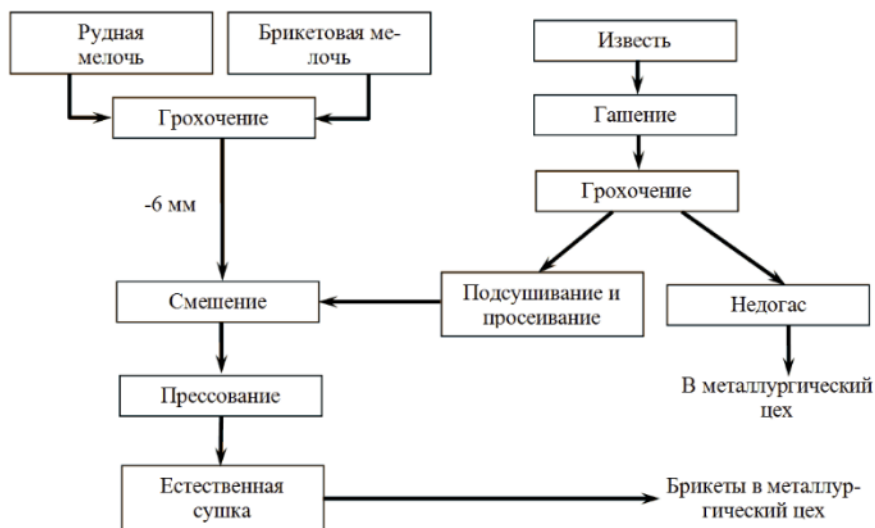
Рис. 13.1. Схема брикетирования сульфидной медной руды с известью (Малова)
