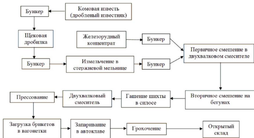
Рис. 11.5. Схема установки комбината КМА-руда для производства автоклавируемых брикетов (Озеров...)
