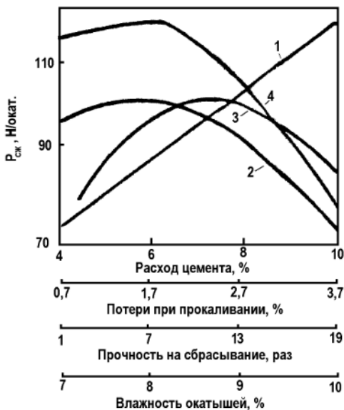
Рис. 9.2. Зависимость прочности P_{сж} пропаренных окатышей от расхода цемента (1), потерь при прокаливании (2), прочности на сбрасывание (3) и влажности (4) окатышей
