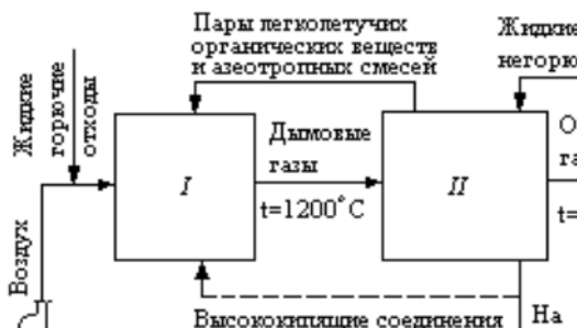
Рис. 7.4. Принципиальная схема установки термического обезвреживания ПО
