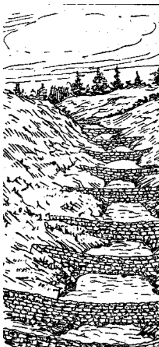
Рис. 5.3. Борьба с оврагообразованием с помощью бьфов
