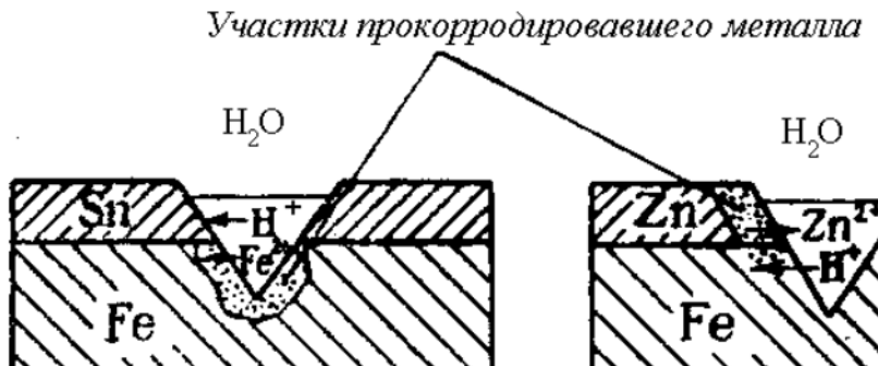
Рис. 5.2. Схема коррозии металла с покрытием
